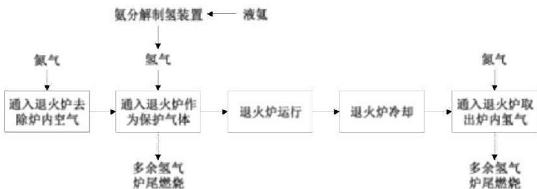
图 2-5 退火工艺流程及产污环节图
